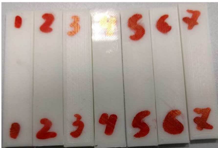
Фотографии элементарных образцов REC ABS до испытаний
